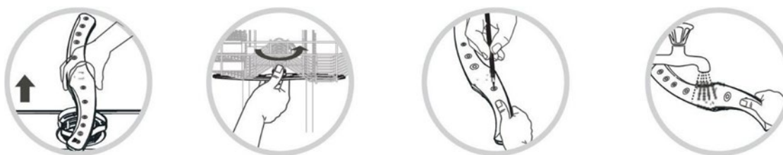
Рис. 30. Порядок снятия и очистки распылительного рукава
